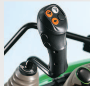
Mechanischen Joystick mit mechanischen Zwischenachsteuergeräten (M-ICV)
