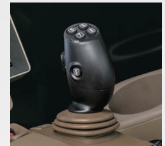
Elektronischer Joystick (E-ICV) im CommandARM integriert – für die Serien 6R, 7R und 8R
