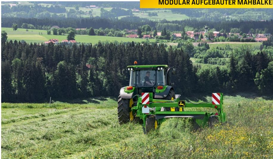
Für maximale Effizienz lässt sich am robusten Rahmen der Heckmähaufbereiter ein Schwadversetzer anbringen. Damit legen Sie zwei Schwade zusammen, die in nur einer Überfahrt aufgenommen werden können.
