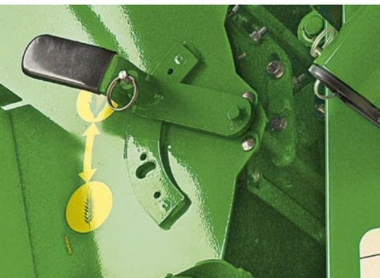
Durch den separaten Nachdrescher für die Überkehr ist es möglich, den Dreschkorb weiter zu öffnen und damit Kraftbedarf und Kraftstoffverbrauch zu senken. Gleichzeitig erzielen Sie eine bessere Strohqualität, da das Erntegut zwischen Korb und Rotor weniger stark verdichtet wird. Zudem kann aufgrund des reduzierten Überkehrvolumens auch das Untersieb weiter geöffnet werden, was wiederum die Durchsatzleistung steigert.
