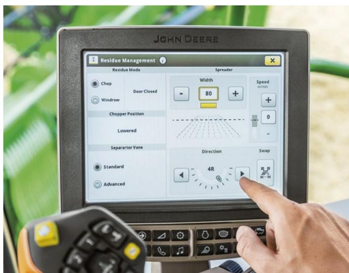
Steurrichtung und -breite stellen Sie bequem von Ihrem Fahrersitz aus ein. Ebenso bequem verstellen Sie nach dem Wenden am Vorgewende per Schalter das Leitblech für den Seitenwindausgleich.
