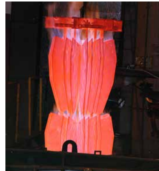
Der 12- stündige Aufkohlungsprozess der Kverneland-Streichbleche bewirkt, dass zwei wichtige Materialeigenschaften innerhalb eines einzigen Werkstückes erzielt werden.
